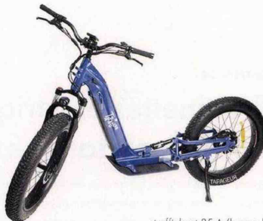
Le modèle tout-terrain de Tapageur se décline avec un mono-moteur 1 000 watts ou deux moteurs de 750 watts.
